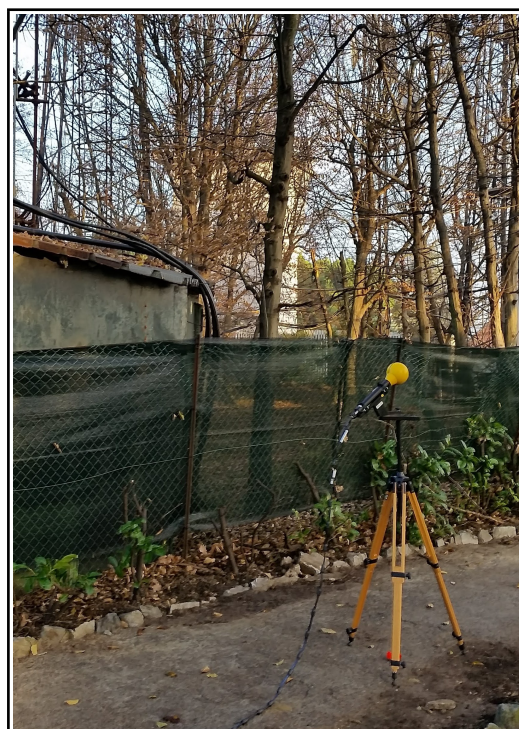
Foto 2 – Sentiero, punto di misura in banda stretta, prossimo ad impianti di radiodiffusione e recinzione metallica
